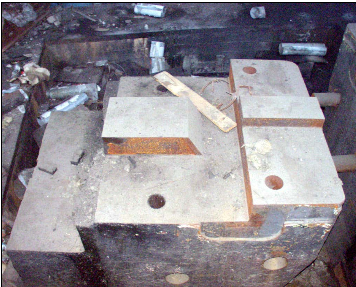
Obr. 4: příklad ocelolitinového podkladního bloku určeného k destrukci
