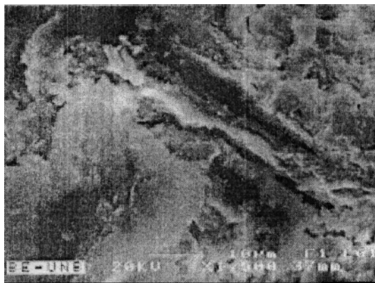
Prostý beton bez ošetření AF, struktura s otevřenými póry
