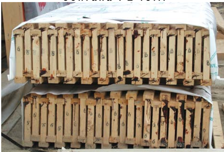
Na obrázku vidíme čela stropních nosníků vyráběných dle požadovaných rozměrů
