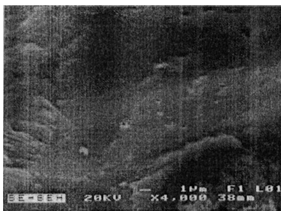
Beton ošetřený AF, uzavřená hustá struktura povrchu
