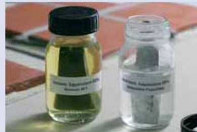
Srovnání chemické odolnosti mezi Remmers SF1 a cementovou výplní spár
