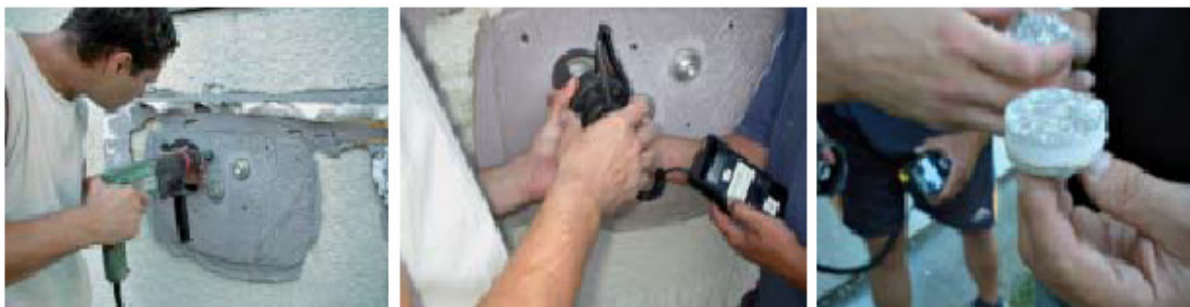
Obr. 1 Odtrhová skúška prídržnosti lepidla a omietky na podklad.
